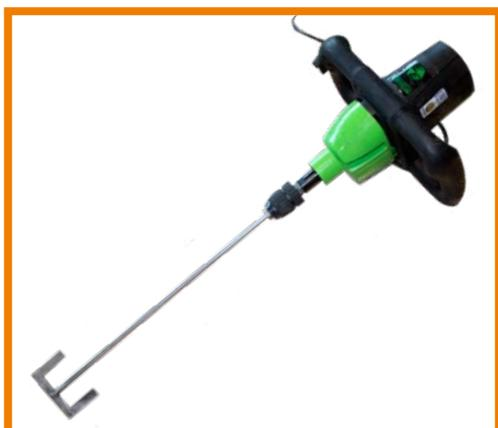
Для смешивания рекомендуется воспользоваться электрическим миксером с ручным приводом, например, медленно вращающейся дрелью (примерно 300 - 400 об/мин), а также лопастной мешалкой группы dga. Специальная конструкция мешалки обеспечивает гомогенизацию усилителя адгезии без образования пузырей и отличается длительным сроком службы.
